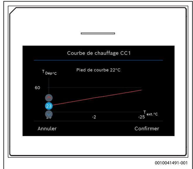
Fig. 3 Régler le pied de courbe (uniquement si le type de réglage est défini sur la température extérieure avec pied de courbe)
