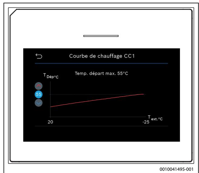
Fig. 5 Régler la température maximale de départ
