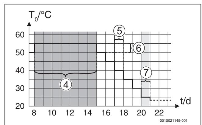
Fig. 8 Déroulement du séchage de dalle avec les réglages de base en phase de refroidissement
