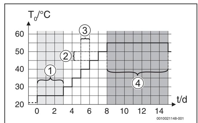
Fig. 7 Déroulement du séchage de dalle avec les réglages de base en phase de mise en température
