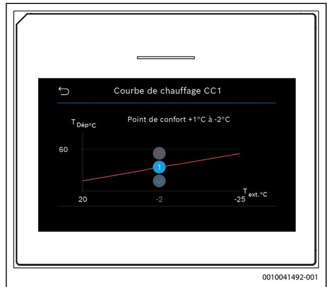
Fig. 4 Régler le point de confort (uniquement si le type de réglage est défini sur la température extérieure avec pied de courbe)
