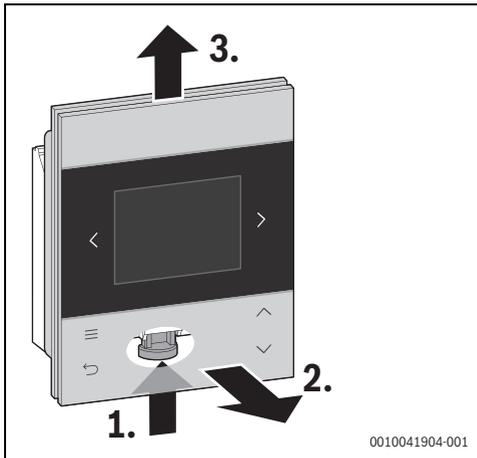
Bild 8 Bedieneinheit abnehmen
