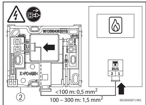
Bild 6 Anschluss der Bedieneinheit an einem Wärmeerzeuger
