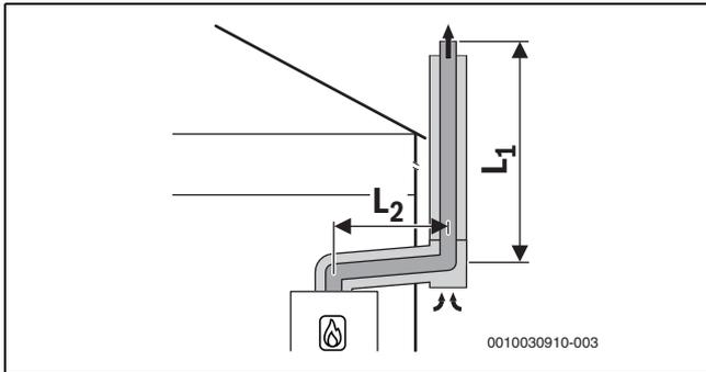
Bild 12 Konzentrische Luft-Abgas-Führung nach C<sub>53x</sub> an der Außenwand
