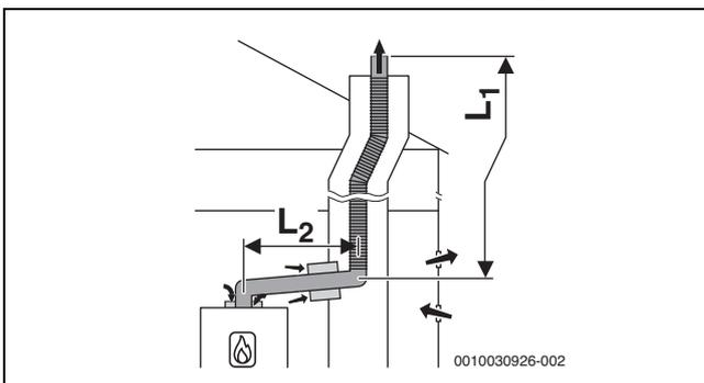
Bild 17 Flexible Abgasführung im Schacht nach B<sub>23p</sub>/B<sub>53p</sub> mit raumluftabhängiger Luftzufuhr am Gerät und konzentrischem Verbindungsstück zwischen Aufstellraum und Schacht
