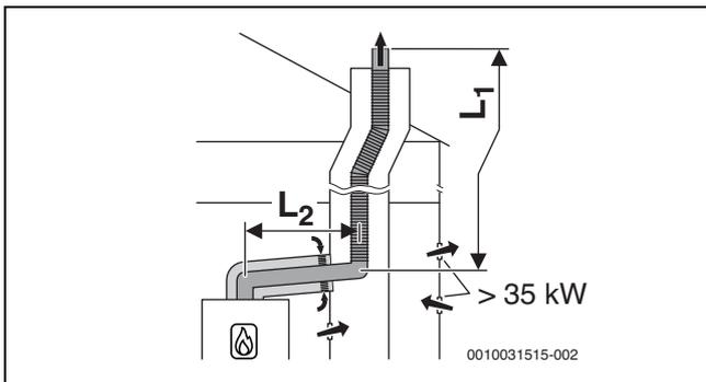
Bild 19 Flexible Abgasführung im Schacht nach B<sub>33</sub> mit raumluftabhängiger Luftzufuhr über die konzentrische Luft-Abgas-Führung im Aufstellraum
