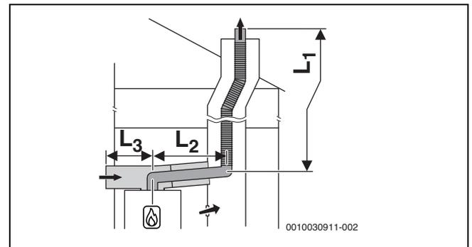
Bild 11 Flexible Abgasführung nach C<sub>53x</sub> im Schacht und Luft-Abgas-Führung mit separater Luftzufuhr und konzentrischer Abgasableitung im Aufstellraum
