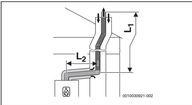
Bild 14 Flexible Abgasführung nach C<sub>93x</sub> im Schacht und konzentrische Luft-Abgas-Führung im Aufstellraum
