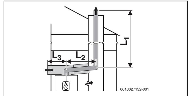
Bild 10 Starre Abgasführung nach C<sub>53x</sub> im Schacht und Luft-Abgas-Führung mit separater Luftzufuhr und konzentrischer Abgasableitung im Aufstellraum
