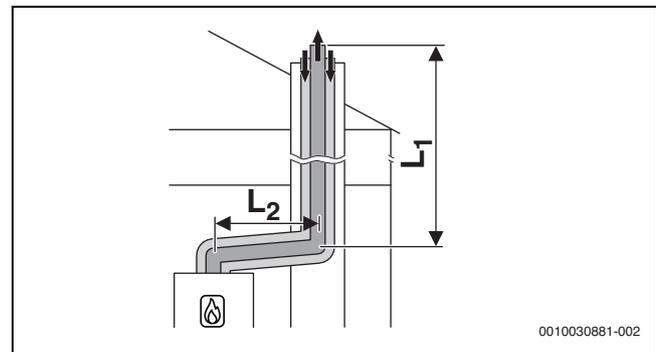
Bild 8 Konzentrische Luft-Abgas-Führung nach C<sub>33x</sub> im Schacht
