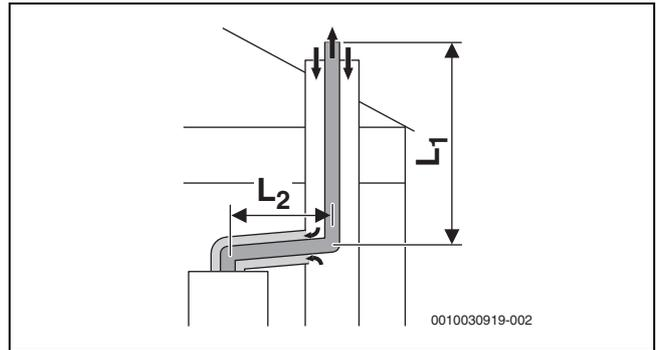
Bild 13 Starre Abgasführung nach C<sub>93x</sub> im Schacht und konzentrische Luft-Abgas-Führung im Aufstellraum
