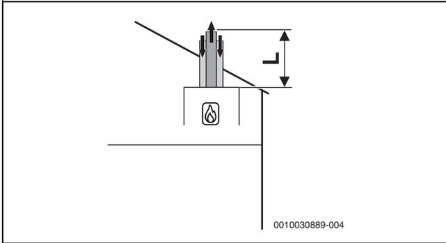
Bild 9 Vertikale konzentrische Luft-Abgas-Führung nach C<sub>33x</sub>
