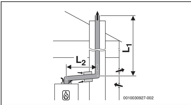
Bild 16 Starre Abgasführung im Schacht nach B<sub>23p</sub>/B<sub>53p</sub> mit raumluftabhängiger Luftzufuhr am Gerät und konzentrischem Verbindungsstück zwischen Aufstellraum und Schacht
