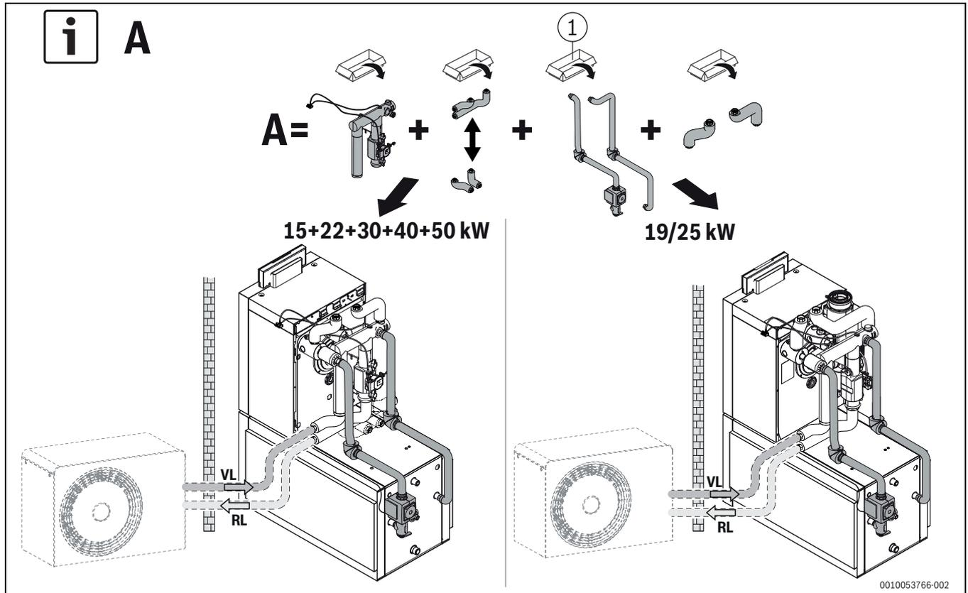
Fig. 10 Collegamento di un bollitore orizzontale, variante A
