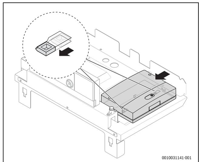
Fig. 18 Installazione del modulo elettronico sotto il pannello di copertura del generatore di calore (esempio)
