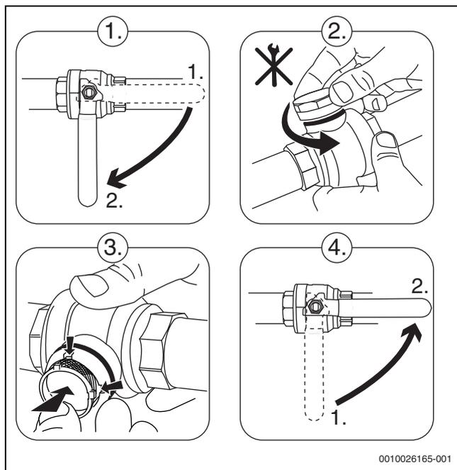
Fig. 32 Smontaggio e montaggio del filtro antiparticolato (esempio)
