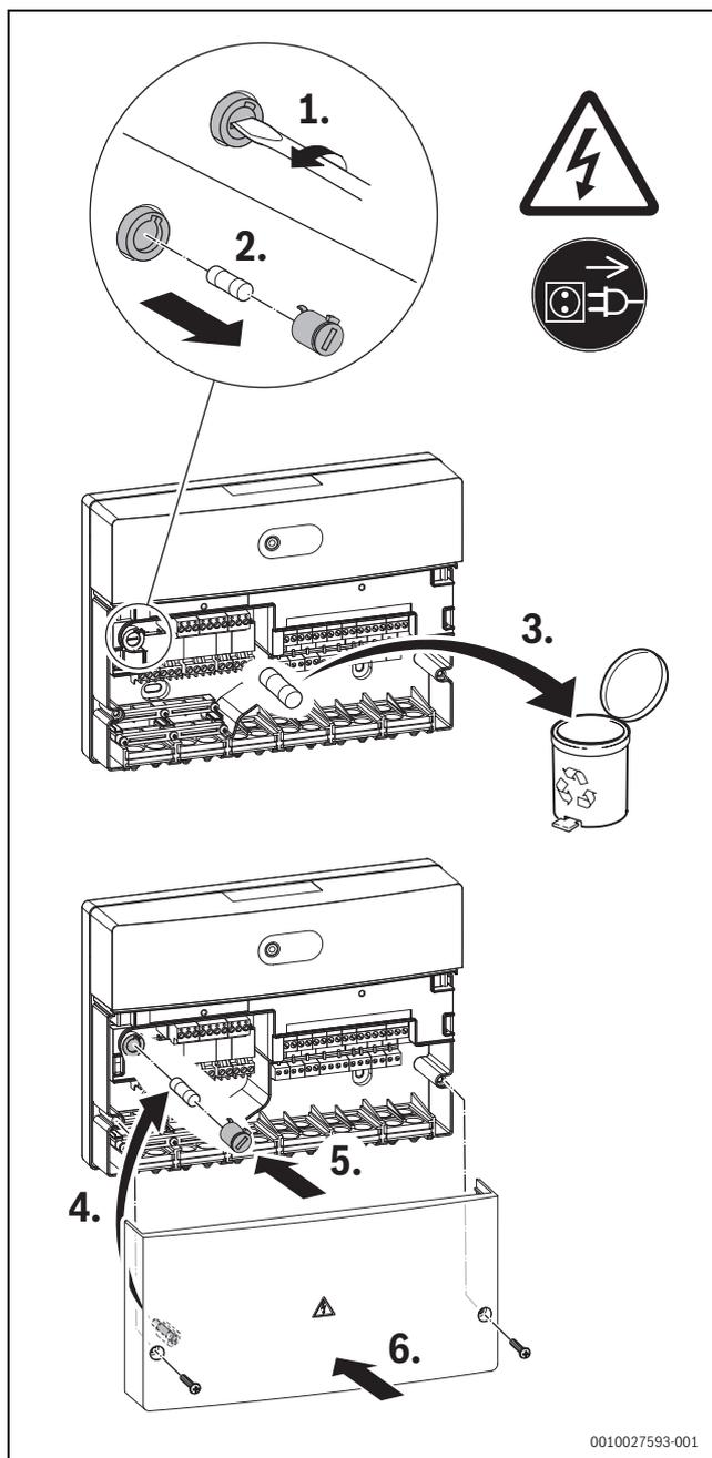
Fig. 34 Sostituire il fusibile
