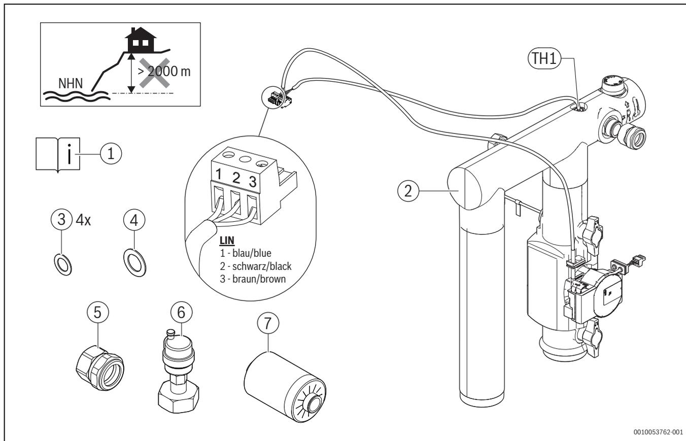
Fig. 1 Volume di fornitura HF-Set HYC40
