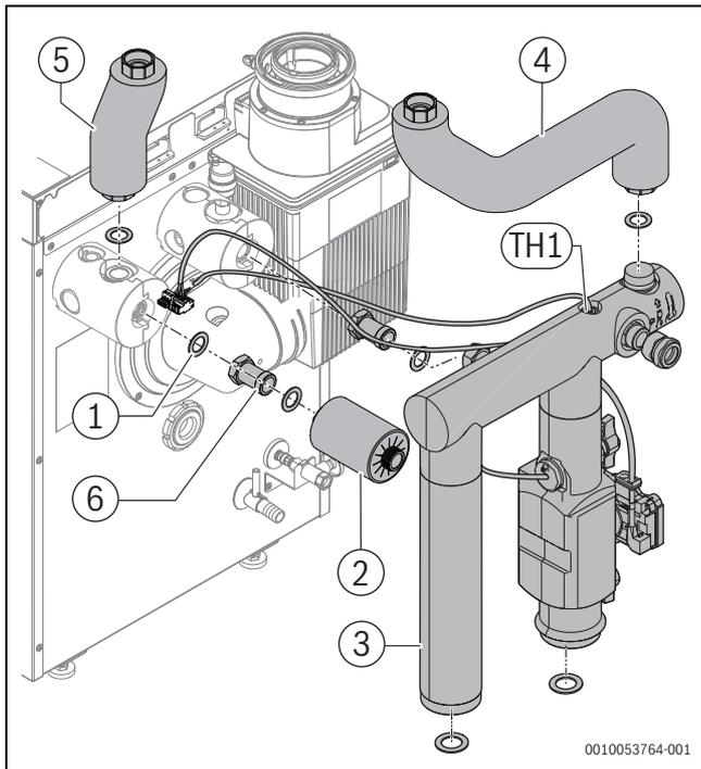
Fig. 7 Installazione del gruppo tubazioni HF-Set HYC40
