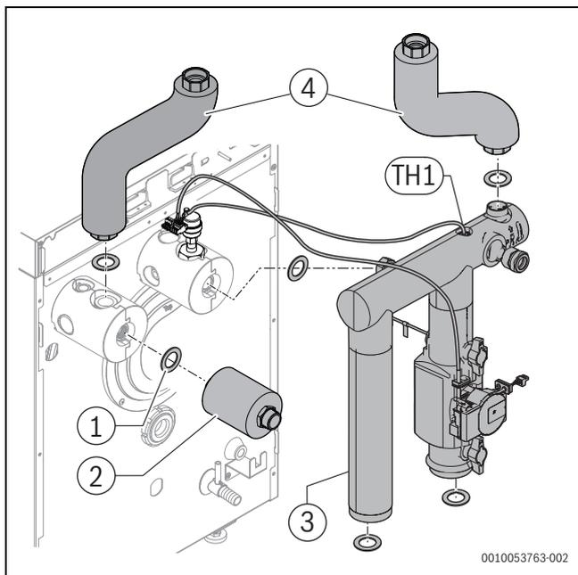
Fig. 5 Installazione del gruppo tubazioni HF-Set HYC40
