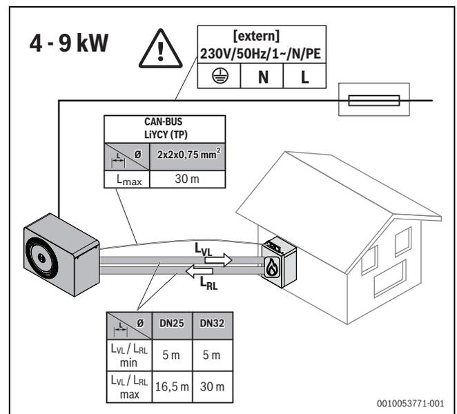
Fig. 8 Requisiti di lunghezza dei cavi elettrici 4 - 9 kW
