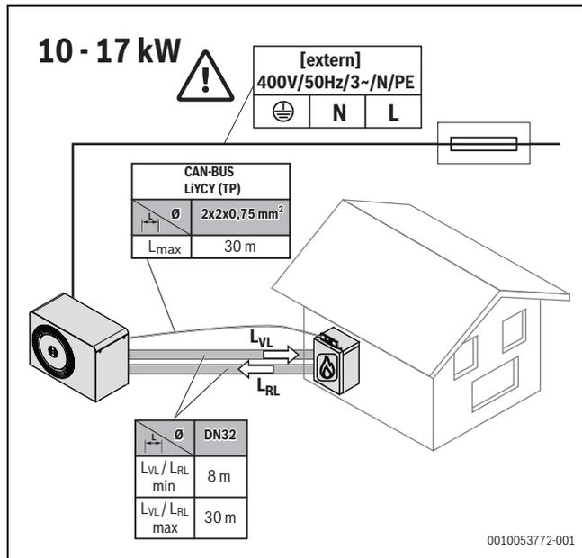
Fig. 9 Requisiti di lunghezza dei cavi elettrici 10 – 17 kW
