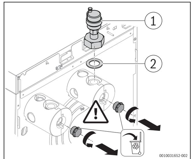
Fig. 4 Installazione del disaeratore automatico
