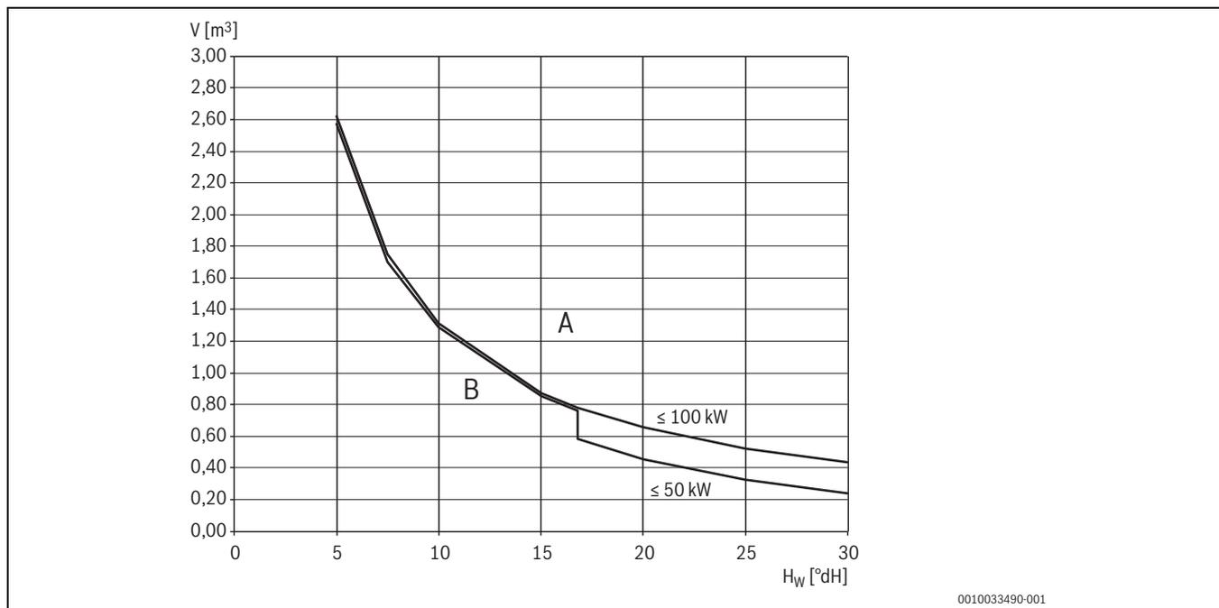
Fig. 24 Limiti di trattamento dell'acqua
