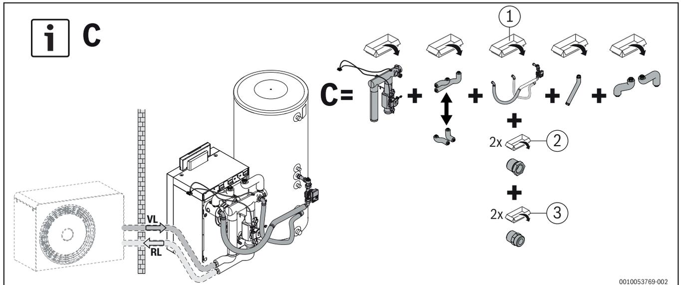
Fig. 14 Collegamento di un bollitore verticale a sinistra, variante B, illustrazione riferita a titolo di esempio a una caldaia da 15 kW
