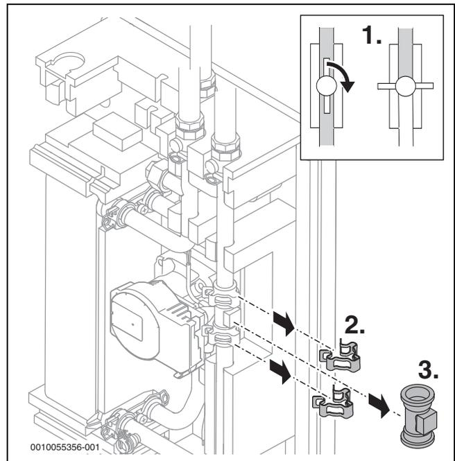
Bild 42 Volumenstromfühler demontieren
