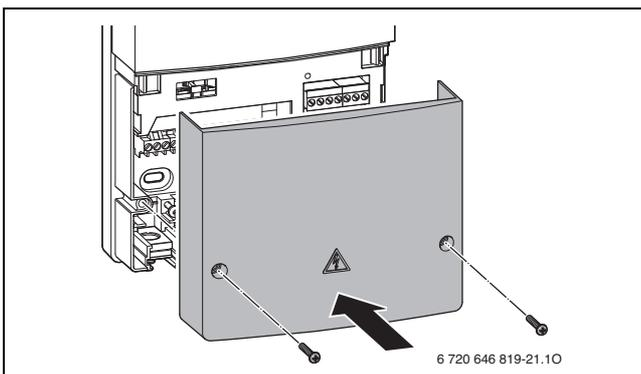
Bild 36 Abdeckung montieren
