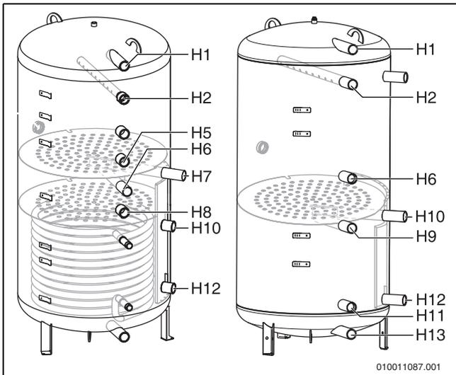
Bild 26 Pufferspeicher mit Trennblechen
