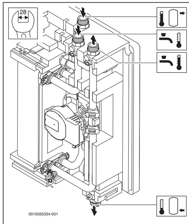
Bild 24 Anschlüsse Frischwasserstation
