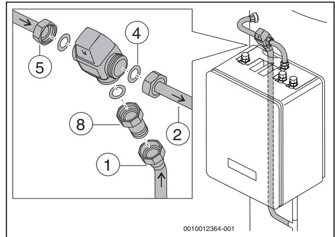
Bild 19 Anschlussrohre handfest verschrauben
