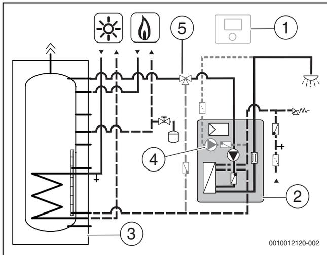
Bild 3 Beispiel: Ausschnitt einer Anlage mit Frischwasserstation (hier: mit Solarkreis und Heizkessel); schematische Darstellung
