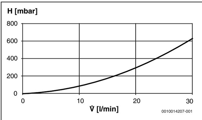
Bild 6 Druckverlust Sekundärseite
