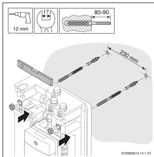
Bild 9 Frischwasserstation an die Wand montieren
