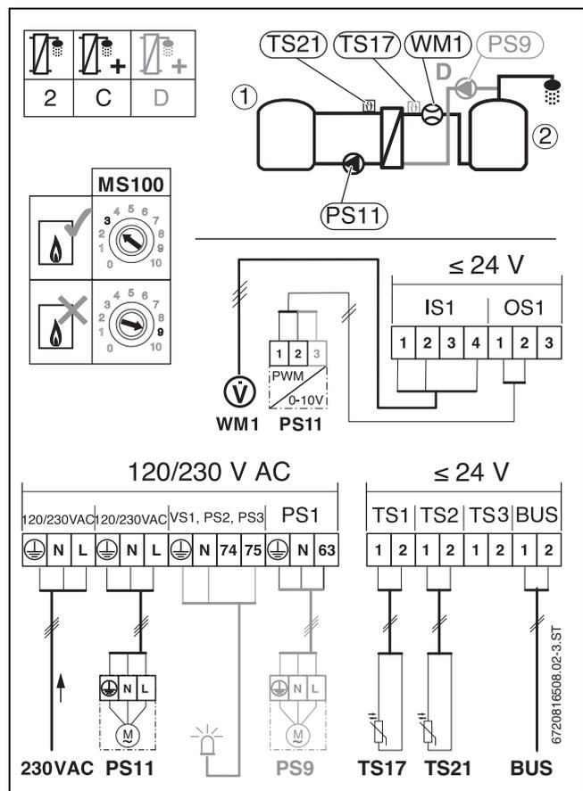
Bild 33 Anschlussklemmen bei Vorwärm-Frischwasserstation
