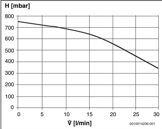
Bild 5 Restförderhöhe Primärkreispumpe
