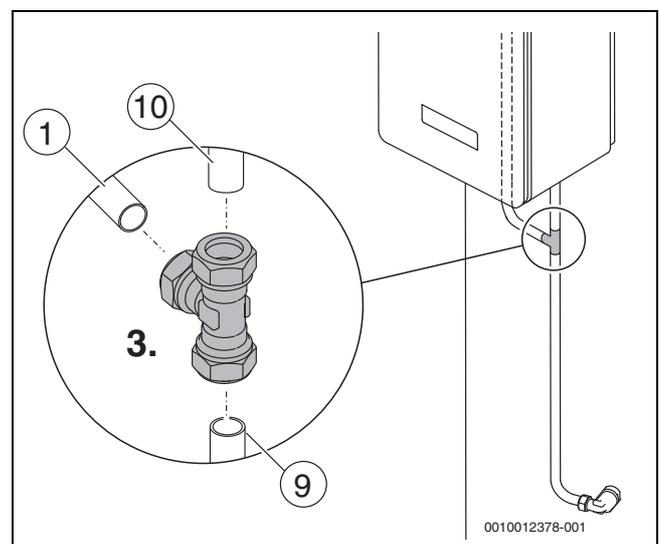
Bild 21 Rohre mit Klemmring-T-Stück verbinden
