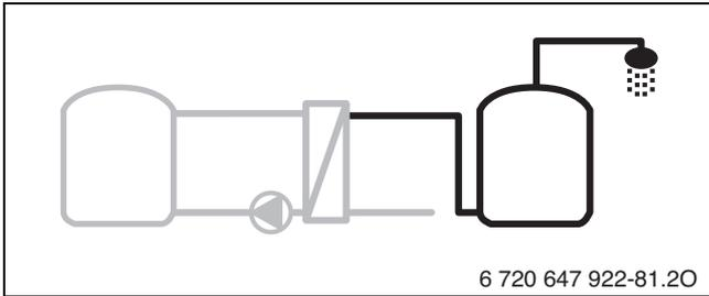
Bild 29 Display: Vorwärmen des Warmwassers mit der Frischwasserstation
