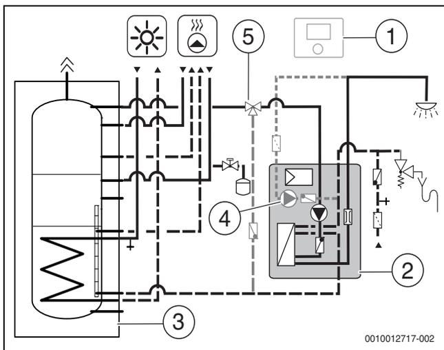
Bild 4 Beispiel: Ausschnitt einer Anlage mit Frischwasserstation (hier: mit Solarkreis und Wärmepumpe); schematische Darstellung
