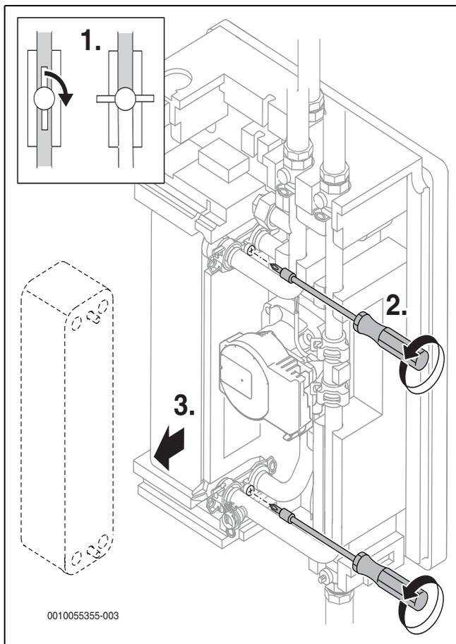
Bild 41 Wärmetauscher demontieren
