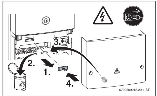
Bild 44 Sicherung tauschen
