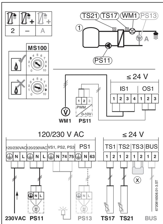
Bild 32 Anschlussklemmen bei Frischwasserstation
