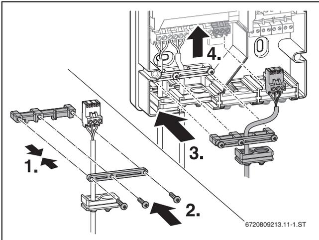
Bild 35 Zugentlastungen montieren und Stecker einstecken
