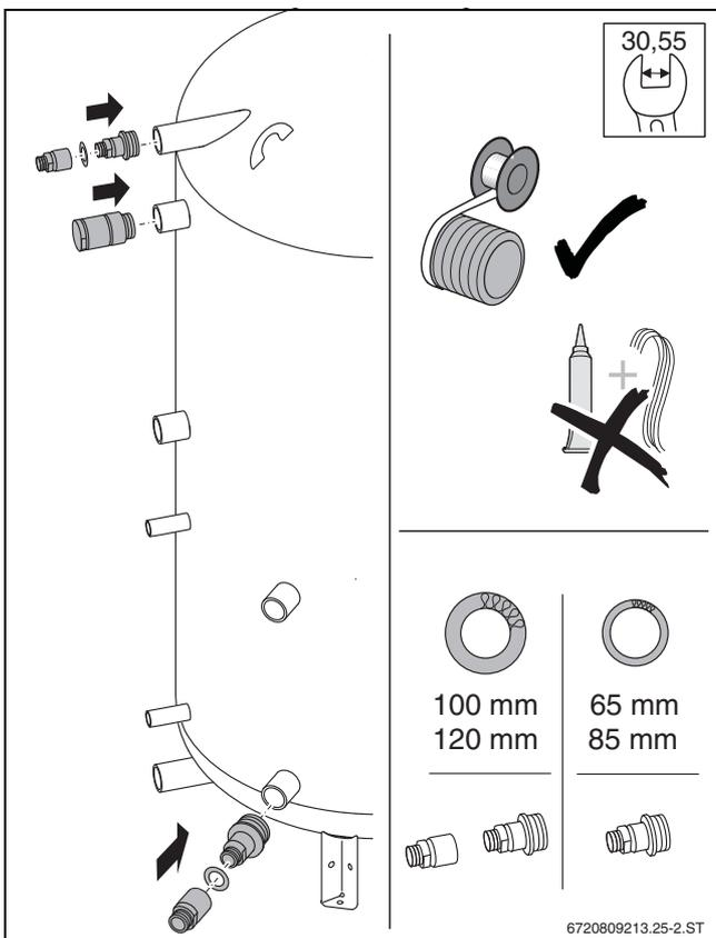
Bild 11 Anschlussstücke einschrauben
