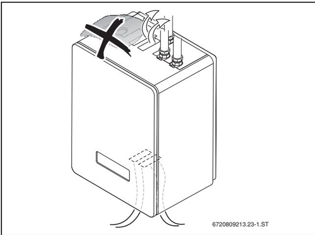
Bild 39 Lüftungsschlitze nicht abdecken
