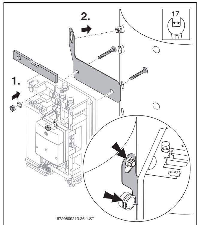
Bild 13 Halteblech montieren
