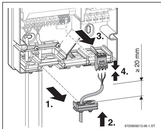
Bild 34 Pumpe anschließen (Zirkulation oder tägliche Aufheizung)
