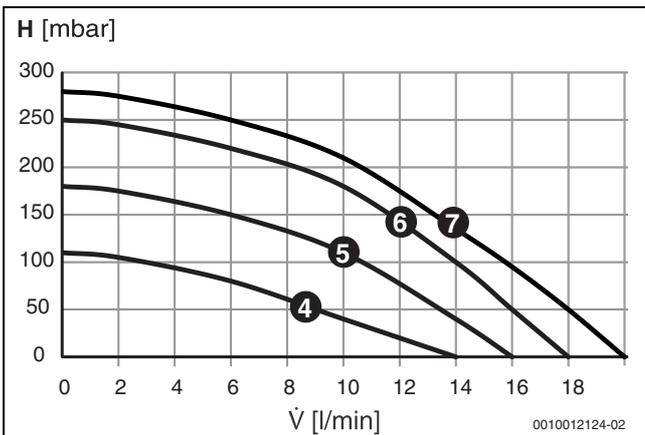
Bild 7 Kennlinie Zirkulationspumpe im Zirkulationsstrang (Zubehör), [4-7] = Pumpenstufen
