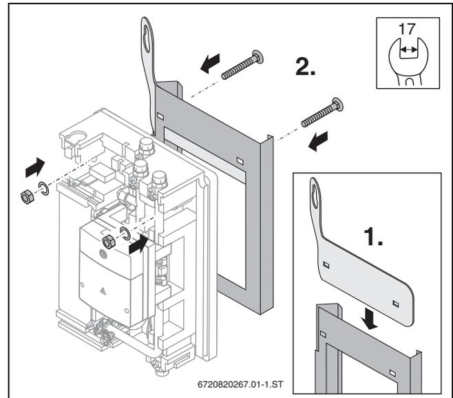
Bild 12 Distanzblech montieren (bei Bedarf)
