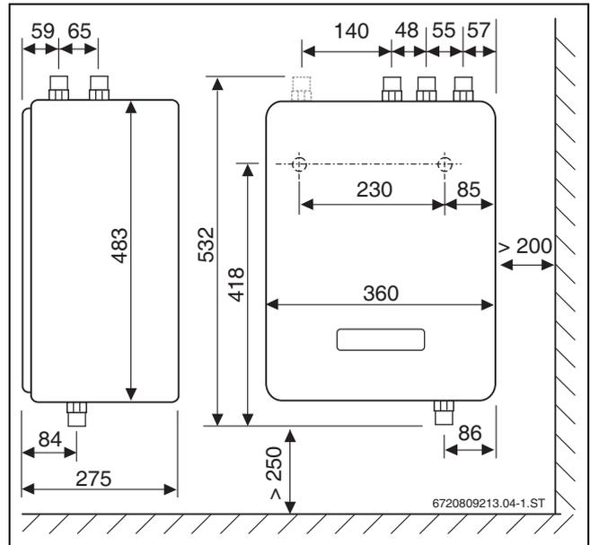
Bild 8 Abmessungen (Maße in mm)
