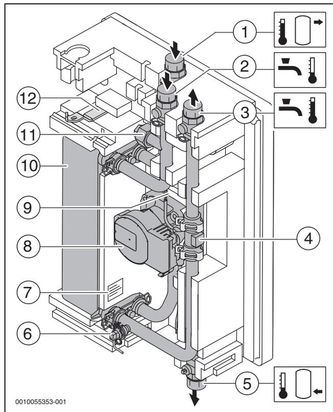
Bild 2 Frischwasserstation ohne vorderen Wärmeschutz, ohne Modul
