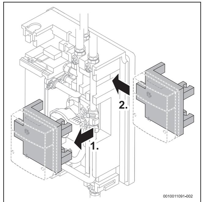
Bild 40 Modul für Wartungszwecke umstecken
