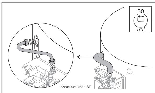
Bild 14 Kurzes Anschlussrohr montieren
