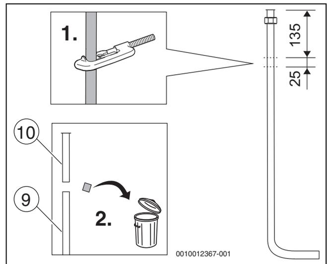
Bild 20 Langes Anschlussrohr vorbereiten
