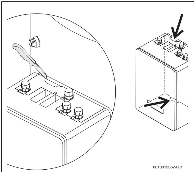
Bild 18 Durchführungen an den Vertiefungen einschneiden
